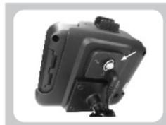
6. Posicione a chave para travar (como visto na imagem), e fixe o GPS ao suporte.
