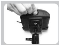
5. Levante a alavanca antes de travar e destravar o GPS.
