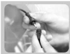
8. Para conectar o GPS ao conector de força, pressione bem a junção à prova de água e rosqueie a tampa para vedar a conexão.
