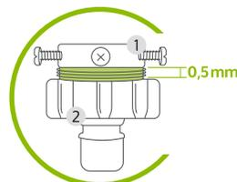
**b.** Em seguida, desrosqueie a peça **2** deixando exposto três voltas completas da rosca (5mm). Este procedimento é muito importante para realizar corretamente a conexão, caso não seja realizado corretamente poderá gerar vazamento nessa região entre a torneira e conector.
