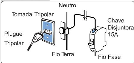
Para a Secadora 127V, utilize um disjuntor de 15A na fase.
