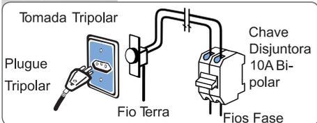
Para a Secadora 220V (entre duas fases), utilize um disjuntor bipolar de 10A.
