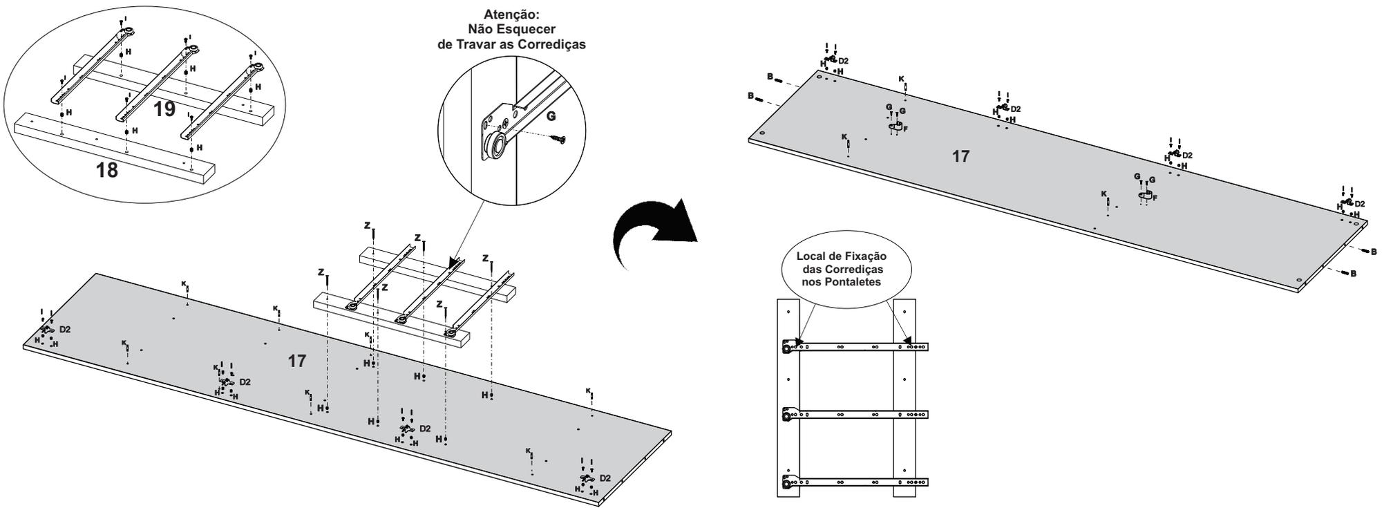
**Passo - 02 Armário** Prepare os rodapés 12, 15 e a travessa 20 com as ferragens abaixo encaixe e fixe conforme imagem abaixo.
