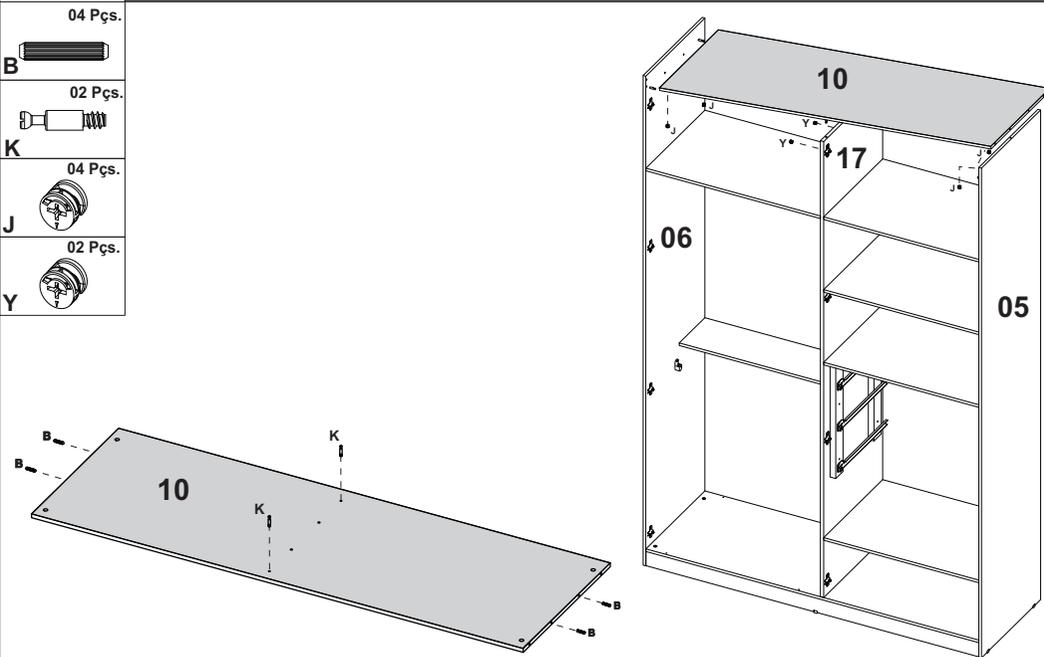
**Passo - 09 Armário** Prepare a Moldura 12 com as ferragens abaixo e encaixe nas laterais 05 e 06 e depois fixe no tampo 10 com a ferragem O.
