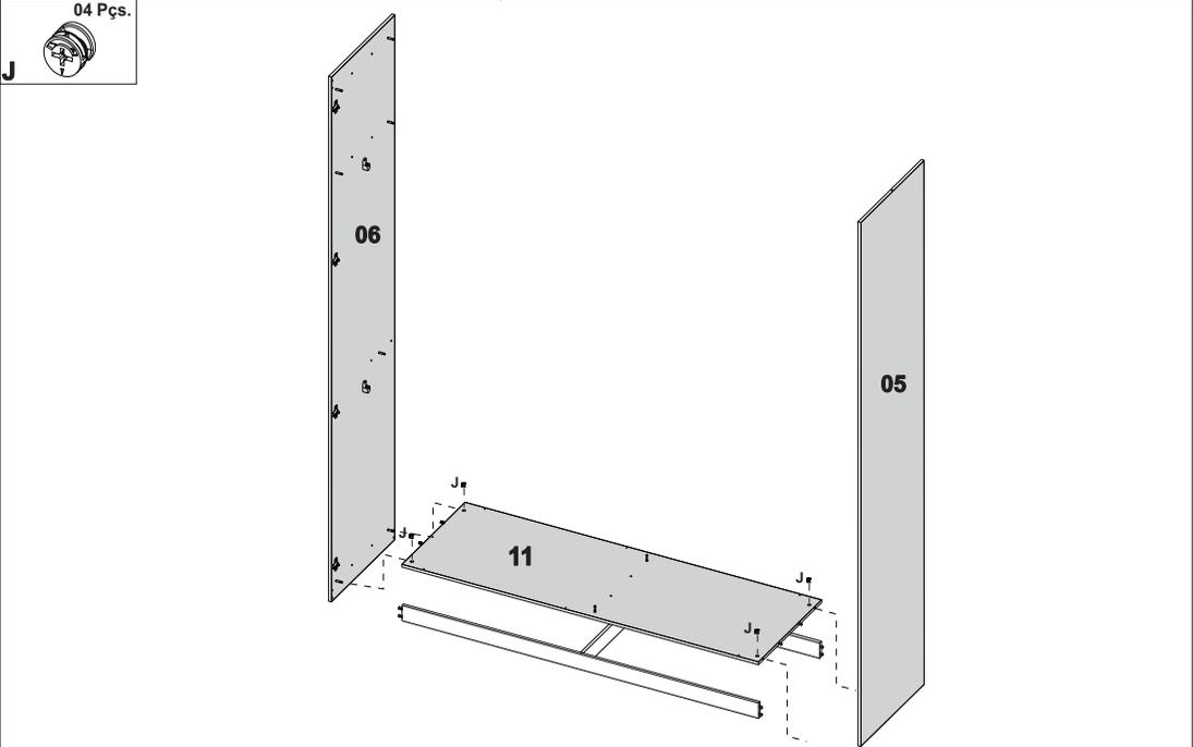
**Passo - 06 Armário** Parafuse o tampo 11 e encaixe o divisor 17 no tampo 11 fixe com as ferragem Y e prepare os tampo 07 e 08 com as cavilas fixando com a ferragem J entre a lateral 06 e divisor 17
