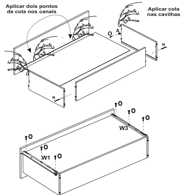
**Passo - 03** Prepare a laterais 05, 06 e o tampo inferior 11 com as ferragens abaixo e prepare os pontaletes 18 e 19 com as correijas e depois fixe na lateral 05.
