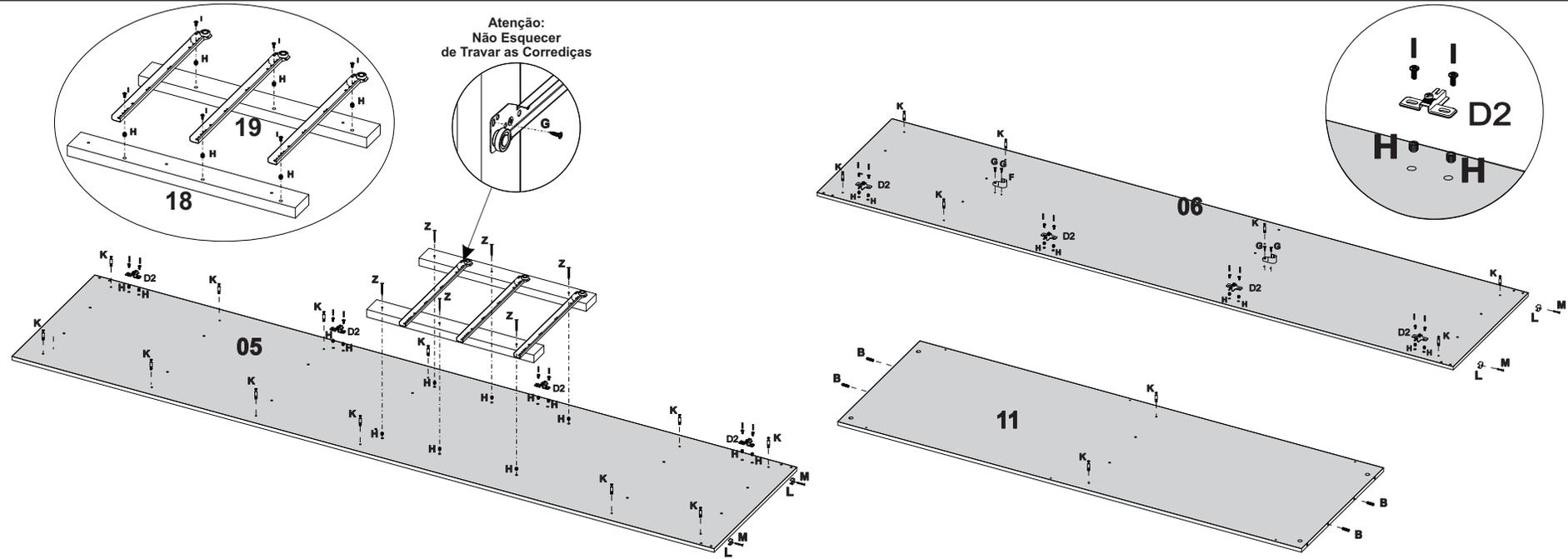
**Passo - 04** Prepare o divisor 17 com as ferragens abaixo conforme ilustração. Iniciar a preparação com a ferragem H fazer toda a colocação nos dois lados da peça antes da fixação do restante das ferragens. Prepare os pontaletes 18 e 19 com as correijas e depois fixe no divisor.
