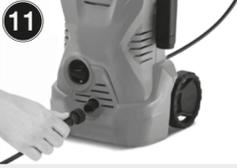
Encaixe até o fim o terminal da mangueira de alta pressão na conexão de saída de água da máquina, em seguida rosqueie a porca giratória no sentido horário até o final.
