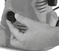
Ligue a máquina, girando o botão para a posição "1/ON".
