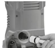
Encaixe o terminal da mangueira de alimentação na conexão de entrada de água da máquina.
