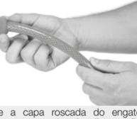
Encaixe a capa rosçada do engate rápido\* na mangueira de alimentação de água (não incluída), que deverá ter diâmetro de 1/2 polegada e comprimento recomendado de 5 a 10m.
