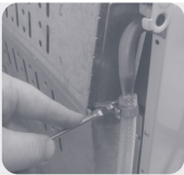
Aperte a abraçadeira com chave de fenda
