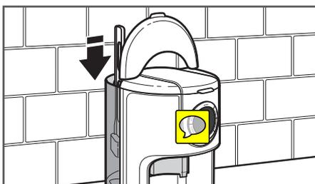
**3** Coloque o cartucho do filtro no fundo do reservatório de água. Empurre o cartucho levemente, para verificar se está ajustado firmemente.
