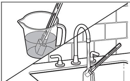
**1** Coloque o cartucho do filtro em um recipiente cheio de água fresca. O cartucho deverá permanecer submerso na água durante 10 minutos. Lave suavemente o filtro com sabão neutro e enxágue em água corrente.
