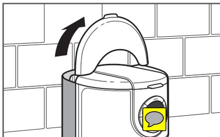
**2** Levante a tampa do reservatório de água usando a aba da parte posterior da tampa.
