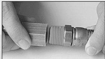
1. Rosqueie o adaptador junto à mangueira metálica flexível. Para auxiliar na vedação, utilize pasta vedante.
