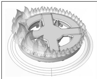
2. Após a instalação do queimador, verifique o acendimento, seguindo as instruções do item “5.4. Acendendo os queimadores da mesa”. O posicionamento incorreto do queimador ou da capa irão resultar em dificuldade de ignição e chamas irregulares (como mostrado na figura ao lado).
