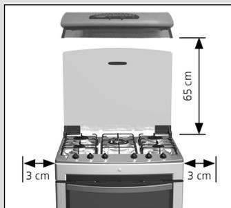
Para o local de instalação, deve-se prever uma distância mínima de 3 cm em toda a volta do fogão, para circulação de ar, e um vão mínimo de 65 cm entre a mesa e qualquer superfície acima dela (armários ou outros produtos, como coifas e depuradores).
