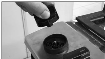
Para facilitar a limpeza, os botões da mesa podem ser removidos. Para removê-los, simplesmente puxe-os para cima quando na posição “fechada”. Para montá-los novamente, basta encaixá-los no eixo, conforme a figura ao lado.
