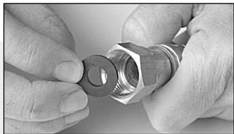
2. Coloque a arruela de vedação dentro da rosca interna da mangueira metálica.
