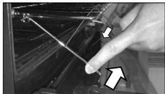
1. Abra a porta do forno e pressione as hastes da prateleira para dentro, conforme figura, para que as mesmas se soltem da porta.
