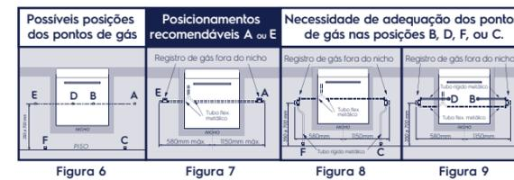
Caso a profundidade do nicho seja inferior a 650 mm, utilize uma conexão "Cotovelo" 90° de Latão Rosca Macho x Fêmea 1/2 polegada, tipo BSP, entre a entrada de gás do forno e a mangueira metálica, para evitar problemas na instalação e no funcionamento.
