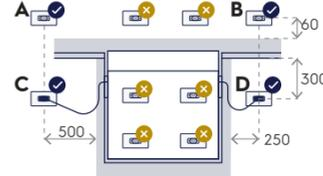
As tomadas A e B devem estar a uma distância máxima do nicho na vertical (60 mm) e na horizontal (500 mm e 250 mm). E as tomadas C e D na vertical (300 mm) e horizontal (500 mm e 250mm), conforme a figura acima.
