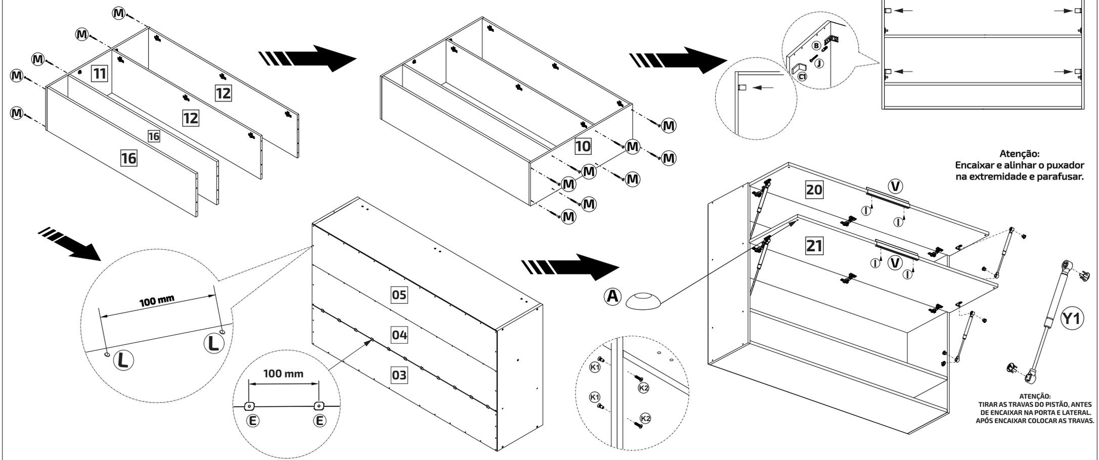
Atenção: Encaixar e alinhar o puxador na extremidade e parafusar.
