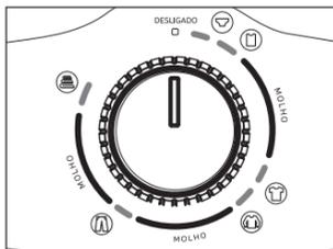
• **Nível d'água manual:** De acordo com a quantidade de roupa a ser lavada, coloque a quantidade de água necessária, respeitando o nível máximo (95 litros). Obs.: Coloque primeiro a roupa dentro da lavadora para depois enchê-la de água.
