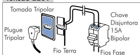
Para a Secadora 220V (entre duas fases), utilize um disjuntor bipolar de 15A.
