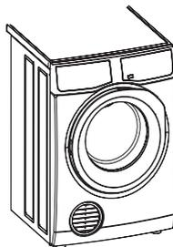
A secadora não deve ser instalada atrás de uma porta com tranca, de uma porta corrediça ou de uma porta com dobradiça no lado oposto ao dela, de modo que a abertura total da porta seja restrita.
