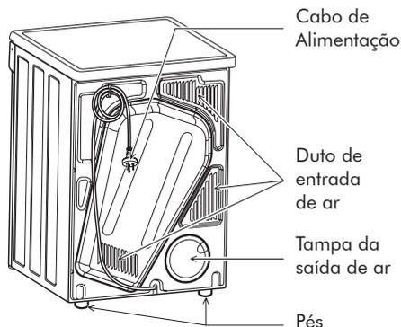
Delicadamente, abra a grade usando uma ferramenta fina. Em seguida, remova a tampa da parte de trás e prenda-a no espaço da grade na frente. A grade de saída de ar não é necessária quando se utiliza um kit de exaustão.
