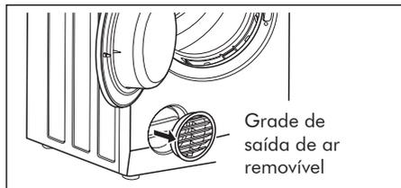
Existem 2 opções de ventilação: frontal e traseira (usando um kit de exaustão).
