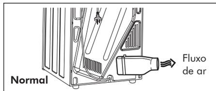
Posicione o kit de exaustão na parte traseira da secadora para remover o ar para cima ou para os lados.
