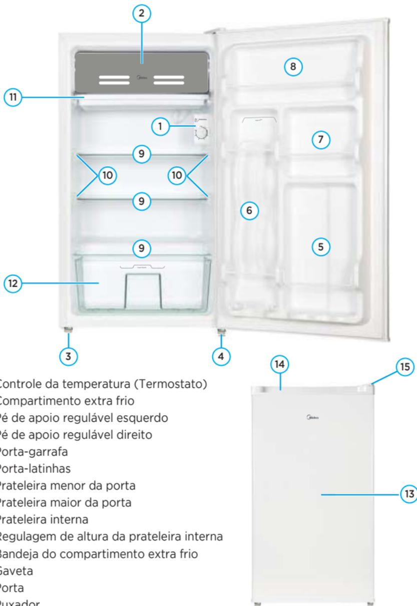
1. Controle da temperatura (Termostato)
