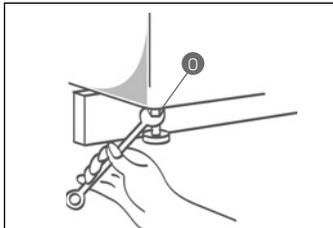
10. Para determinar se a sua Lava & Seca está nivelada corretamente, fique de frente para o produto, apoie as duas mãos na parte superior frontal e balance. Se o produto balançou, ainda não está bem nivelado.
