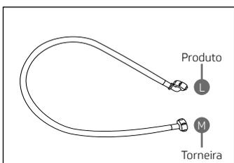
3. Conecte a extremidade **curva** **L** da mangueira de entrada de água na abertura de encaixe posicionada na parte superior traseira da Lava & Seca. Não retire o filtro que está encaixado na válvula da sua Lava & Seca.
