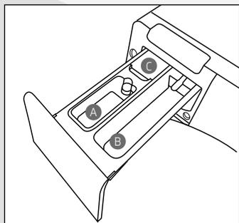
O Dispenser é uma gaveta com 2 compartimentos (amaciante **A**, sabão **B**) que armazenam e os distribuem automaticamente os insumos durante as etapas da lavagem. Para usá-lo, basta puxar com uma mão para abrir, abastecê-lo conforme as instruções a seguir e fechar, empurrando-o para dentro suavemente para evitar que os produtos derramem.
