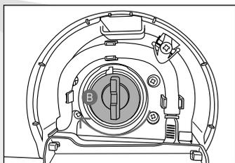
4. Remova a tampa do compartimento **B**, girando-a no sentido horário, de acordo com a figura ao lado.
