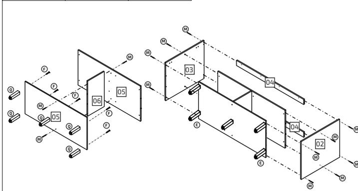
**Passo 03** Montar os fundos 01 conforme a ilustração abaixo, utilizando suas respectivas ferragens.
