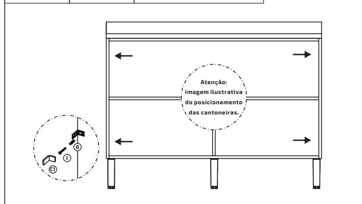
**Passo 07** Aplicar a logo Bartira no móvel, preferencialmente na lateral esquerda alinhada, em seguida fazer a união dos módulos conforme a ilustração abaixo.
