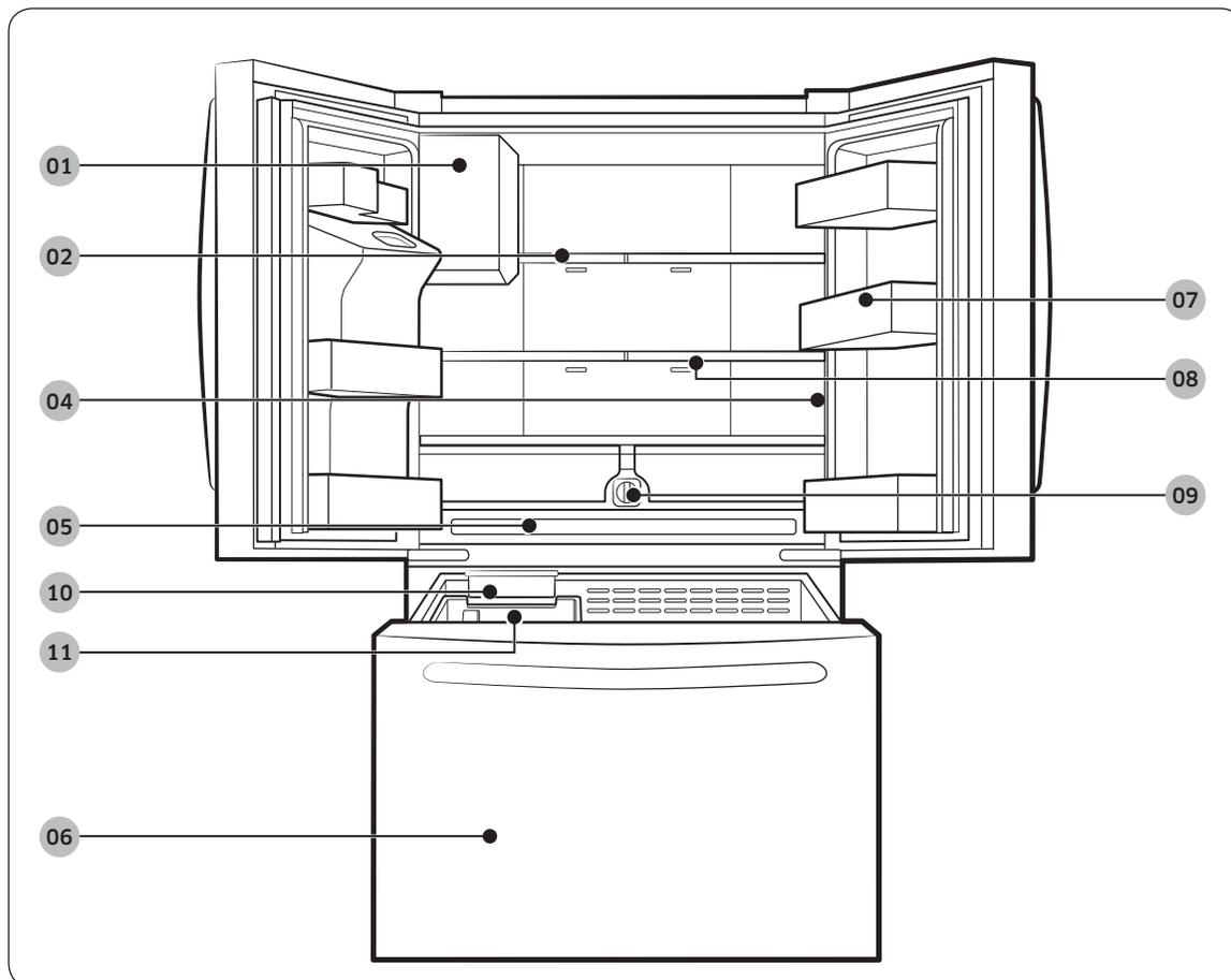
**01** Mecanismo de fabricação de gelo automático
