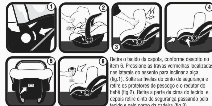
Retire o tecido da capota, conforme descrito no item 6. Pressione as travas vermelhas localizadas nas laterais do assento para inclinar a alça (fig.1). Solte as fivelas do cinto de segurança e retire os protetores de pescoço e o redutor do bebê (fig.2). Retire a parte de cima do tecido e depois retire o cinto de segurança passando pelo tecido e pelo corpo da cadeira (fig.3).
