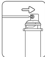
3. Perto de um lugar de descarte de água, conecte a mangueira na entrada do cabeçote de limpeza conectado ao filtro ("IN"). Abra o registro de água e deixe fluir aproximadamente 10 litros de água. Logo após, feche o registro.
