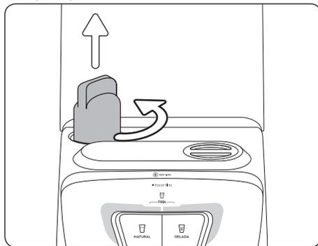
5. Retire o cabeçote de limpeza conectado ao filtro novo e coloque o mesmo no purificador de água, girando no sentido horário até travar.
