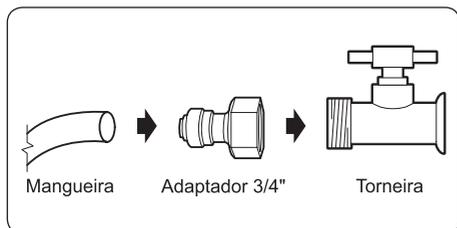
3. Caso opte por adquirir o acessório adaptador de adaptador 21mm (1/2") e a tampa cega, antes de instalar, utilize uma fita veda rosca nos mesmos.
