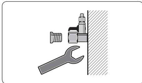
Conecte a mangueira ao conector 13,6mm (1/4"), retirando a porca e passando-a através da mangueira.
