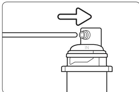
6. Com uma caneta, marque 17 mm na ponta da mangueira que será conectada atrás (na entrada de água) do purificador.
