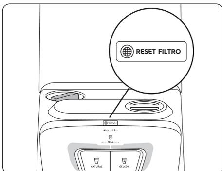
11. Abra o registro de água. Pressione a tecla "GELADA" e aguarde até que comece a sair água. Pressione a tecla novamente para interromper o fluxo de água. Para higienizar o aparelho, retire a tampa de higienização. Coloque uma colher de chá de vinagre incolor para tirar o gosto de plástico.
