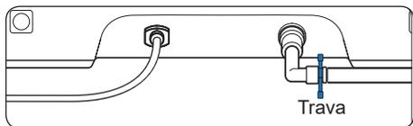
8. Abra o registro de água. Pressione a tecla "GELADA" e aguarde até que comece a sair água. Pressione qualquer tecla para parar o fluxo. Para higienizar o aparelho, feche a entrada de água e retire a tampa de higienização. Coloque uma colher de chá ou 5 ml de vinagre incolor para higienização.
