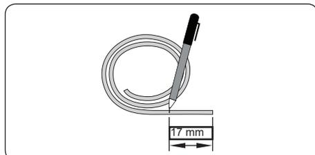
Para reinstalar o purificador, corte um pedaço da mangueira de maneira a retirar a parte "arranhada" e proceda com a marcação dos 17 mm, conforme orientação acima.
