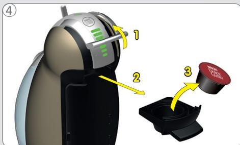
4 Abrir a alavanca de perfuração e remover o suporte para cápsula.
