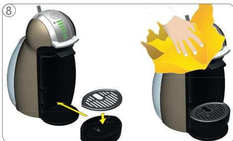
8 Colocar o suporte de xícaras no suporte de gotejamento e posicioná-los na máquina. Limpar o exterior da máquina com um pano macio e úmido. Secar depois a máquina com um pano macio e seco.
