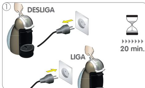
1 Desligar a máquina. Verificar se a cápsula se encontra obstruída (ver a pág. 12). Desligar o plugue da tomada e aguardar 20 minutos. Depois, colocar novamente o plugue na tomada e ligar a máquina.
