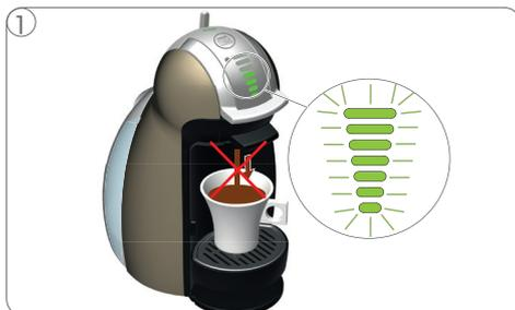
1 Erro: a preparação da bebida interrompe ou não inicia. O display de luz pisca e o botão liga/desliga fica verde e vermelho rápido.
