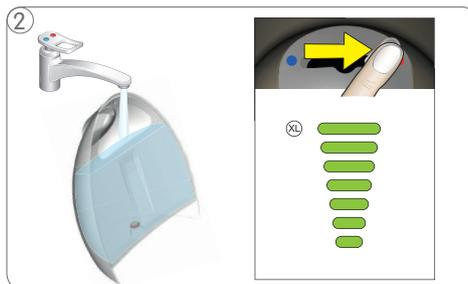
2 Verificar se há água no reservatório. Se não, encher o reservatório de água e apertar novamente o botão "liga/desliga". Se nenhum líquido sair mesmo que ainda haja água no reservatório, proceder como descrito a seguir:
