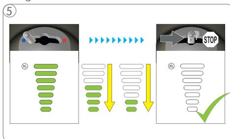
5 A máquina inicia o ciclo de lavagem. As luzes apagam gradativamente enquanto a água está sendo escoada. Aguardar até a máquina parar.
