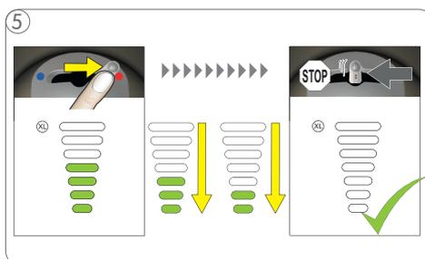
Mova a alavanca para a direita para bebidas quentes e para a esquerda para bebidas frias. A preparação da bebida se inicia. As luzes se apagam gradativamente e a máquina para automaticamente ao fim do preparo. Espere até que a alavanca retorne para a posição neutra e a extração pare. A extração pode ser interrompida manualmente ao mover a alavanca de volta para a posição central.
