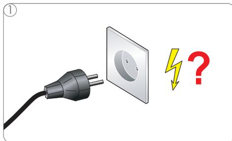
1 Verificar se a tomada está energizada, se a tensão elétrica (voltagem) da mesma é compatível com o produto e se o plugue está corretamente conectado.
