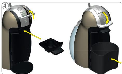
4 Abrir a alavanca de perfuração e colocar o suporte para cápsula vazio (sem cápsula). Fechar a alavanca de perfuração e colocar um recipiente no bocal de saída.
