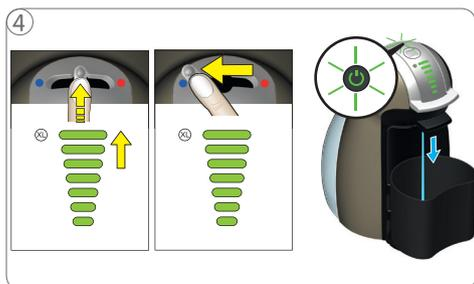
4 Inicie o ciclo de lavagem com água gelada: Empurre a alavanca para cima até a barra atingir o nível máximo, em seguida mova a alavanca para o lado esquerdo para que a água fria escoe.
