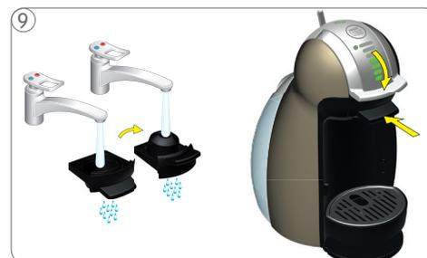
Enxaguar e secar o suporte para cápsula (enxaguar com água de ambos os lados). Colocá-lo novamente na máquina. Deguste sua deliciosa bebida!
