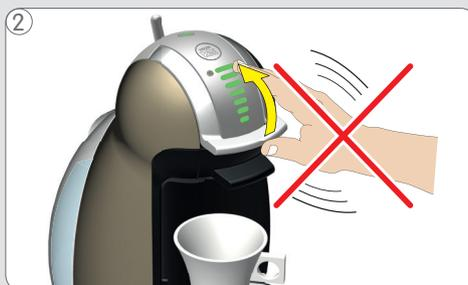
2 Não forçar o levantamento da alavanca de perfuração.
