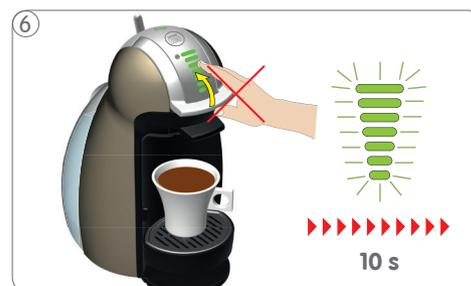
Depois de preparar a bebida, aguarde 10 segundos até a luz vermelha apagar. **Durante este ciclo, não abrir a alavanca de perfuração!**
