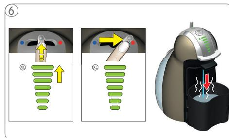
6 Para enxaguar a máquina: Empurre a alavanca para cima até a barra atingir o nível máximo, em seguida mova a alavanca para o lado direito. A máquina inicia a lavagem. As luzes se apagam gradativamente.
