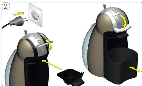
2 Abrir a alavanca de perfuração e colocar o suporte para cápsulas vazio (sem cápsula). Fechar a alavanca de perfuração. Coloque uma jarra de um litro em baixo da saída de água. Conecte o cabo de alimentação à energia elétrica.
