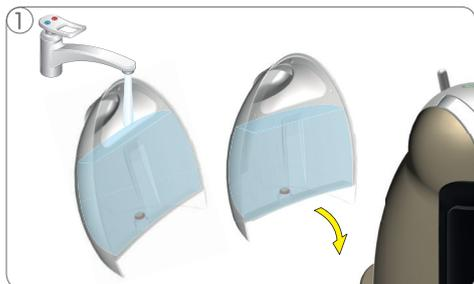
1 Lavar e enxaguar bem o reservatório de água. Encher o reservatório com água potável fresca. Colocar a tampa e instalar o reservatório na máquina.
