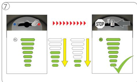
7 A máquina inicia o ciclo de lavagem. As luzes apagam gradativamente enquanto a água está sendo escoada. Aguardar até a máquina parar.
