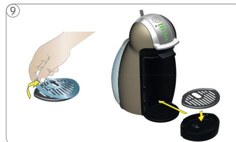
9 Remover a película protetora do suporte de xícaras. Colocar o suporte de xícaras no suporte de gotejamento e posicioná-los na máquina.
