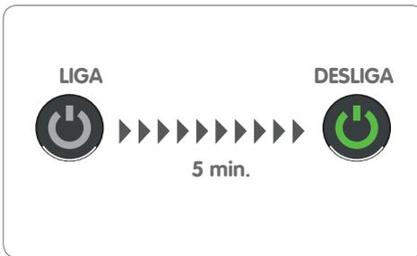
Após 5 minutos sem utilização, a máquina desliga-se automaticamente (Modo Econômico). Para reiniciar, apertar o botão.
