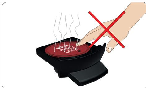
⚠ Não tocar na cápsula usada após a preparação da bebida! Superfície quente! Risco de queimadura! Manusear o suporte para cápsula pelo puxador de metal.
