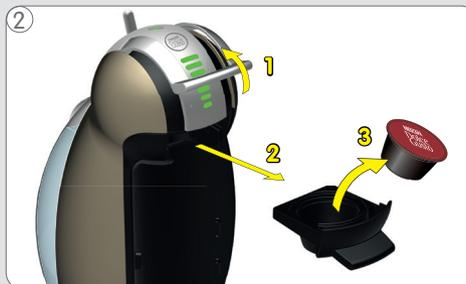
Abrir a alavanca de perfuração e remover o suporte para cápsula.
