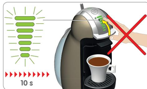
⚠ Após preparar a bebida aguardar 10 segundos até a luz vermelha apagar. **Durante este ciclo, não abrir a alavanca de perfuração!**
